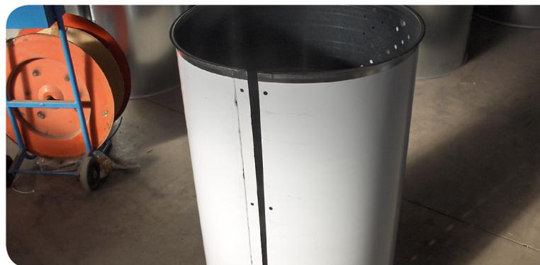
Accostare il secondo modulo dentro il collare prima in basso e poi, dopo averlo accostato completamente, sovrapporre la parte superiore del collare, prima quella più lunga che resterà sotto e successivamente la parte più corta che si sovrapporrà alla prima. Infine serrare il collare con la vite ed i dadi in dotazione.
